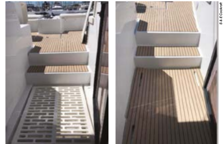
Grille du dalot d'évacuation ouverte en navigation et fermée au mouillage
