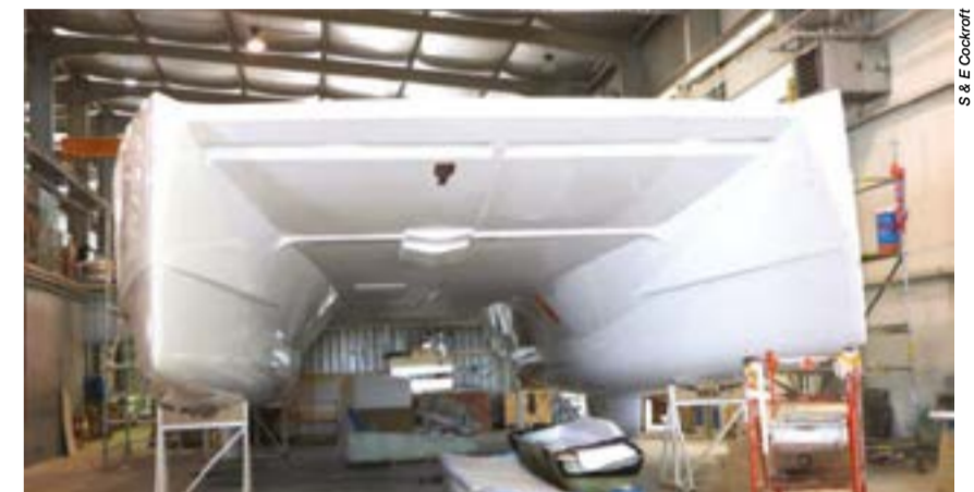
Pont et coques d'une seule pièce pour plus de rigidité structurelle
